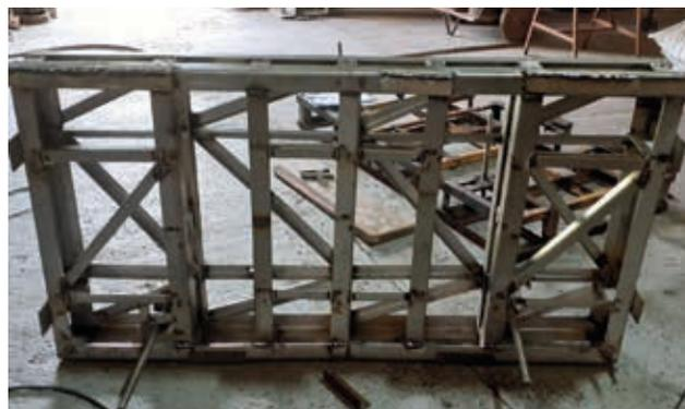
Estrutura de aço inox a ser chumbada na base do *Laçador* e ligada à estrutura interna – Vista superior.
